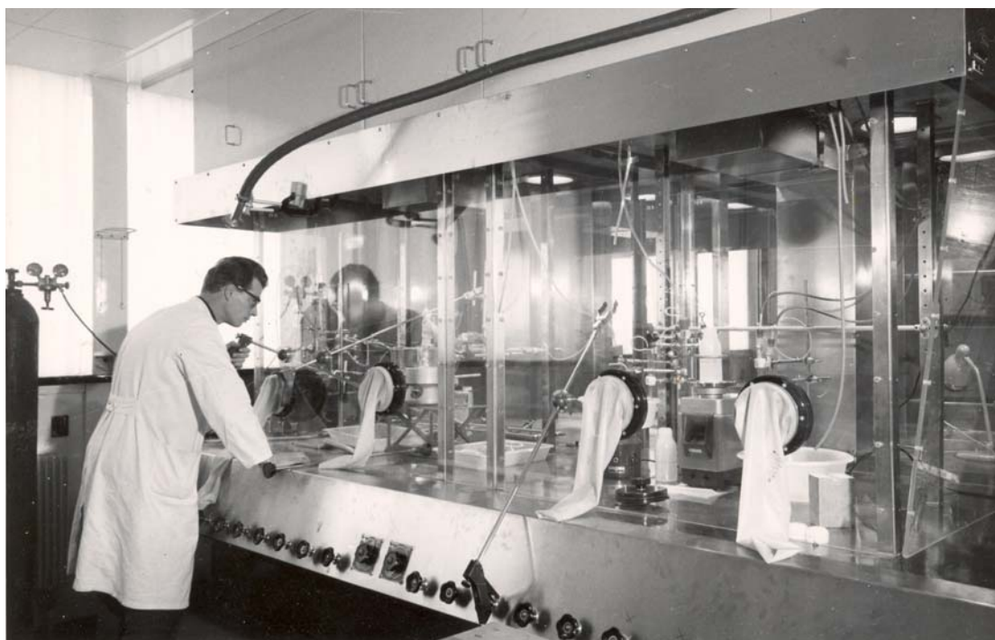
Figur 10. Celle indrettet til radiokemisk separation af ^{32}\text{P} , som er en ren beta-emitter. Der behøves derfor kun en afskærmning af plexiglas for at beskytte personen mod strålingen. Forskeren på billedet er civilingeniør Børge Kruse, som var ansvarlig for en stor del af laboratoriets isotoparbejde i de første mange år. Isotoplaboratoriet leverede fra starten i 1959 store mængder såkaldt carrier-free ^{32}\text{P} til undersøgelser af afgrøders næringsoptagelse både på Risøs egen Landbrugsforsøgsafdeling og dets statslige forsøgsvæsen. Foto fra 1960. Steno Institutets Billedsamling.
