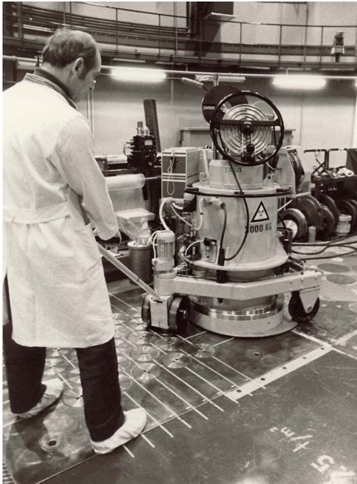
Figur 16. Mennesket og tyren . I en blyafskærmet Si-flaske flyttes en færdigbestrålet Si-krystal fra det forsøgsrør, hvori den er blevet bestrålet til lagerområdet, hvor den skal stå til "afkøling" i en uges tid. Herefter er strålingsniveauet så lavt, at krystallerne kan håndteres med de bare næver. I reaktoroperatøernes jargon gik Si-flasken under navnet "den røde tyr", fordi den var så vanskelig at styre! Personen på billedet er reaktormester K. Bue Olsen. Foto fra sidst i 1970'erne. Risøs Billedarkiv.
