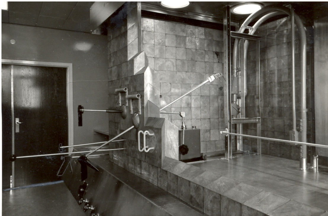
Figur 9. Isotoplaboratoriets sende/modtagestation for bestrålinger via rørpost. Til højre i billedet ses selve rørposten, som gik direkte over i DR2. I midten af 1960'erne blev der også indrettet en rørpostforbindelse til Risø's største reaktor DR3. Til rørpostbestrålinger var bestrålingsdåsen lavet af magnesium (en såkaldt "kanin"). Efter endt bestråling dumper den aktiverede prøve ned i en speciel vogn, der ses ved siden af blyvæggen. Med fjerngreb (såkaldt "telematisk udstyr") kunne det radioaktive materiale udtages af prøvebeholderen ved hjælp af manipulatorerne. Hele processen foregik bag en afskærmning på 10 cm bly, der skulle beskytte personalet mod beta- og gammastrålingen. En del af afskærmningen er fjernet, for at vi kan se ind i arbejdscellen Billede fra 1960, Steno Institutets Billedsamling.
