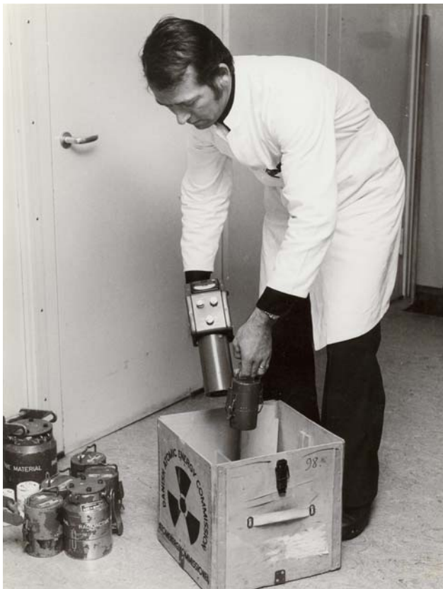
Figur 13. Før forsendelse blev det radioaktive materiale emballeret i specielle blyfurede transportbeholdere og placeret midt i en trækasse med luft til alle sider. Trækasserne var designet til at møde de særlige internationale krav til transport af radioaktivt materiale. Personen på billedet er forsøgsassistent Mogens Offersen, som er i færd med at kontrollere strålingsniveauet med en transportabel strålemonitor af "cutie pie"-typen. Foto fra 1970'erne, Risø's Billedarkiv.
